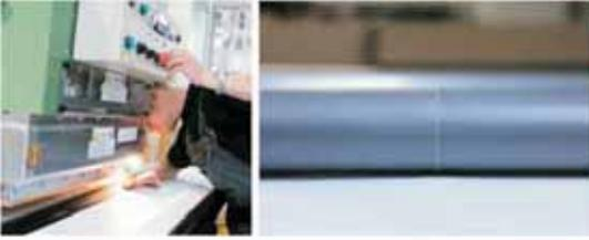
Best Vision kaynaklı kumaşları direkt olarak ithal etmektedir, kaynak teknolojisi henüz ülkemizde gereken seviyelerde değildir, ekrana görüntü yansıtıldığında gözünüzü rahatsız etmeyecek bir kaynak yapılmalıdır. Best Vision ekran kaynağı konusunda en yetenekli firmalarla çalışmaktadır, öyle kaynak kalınlığı 0.8mm'dir bu şu demektir siz kaynağı görmek isterseniz de göremezsiniz.
