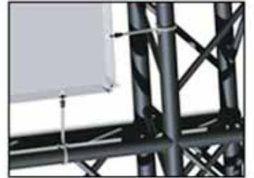
Ürünün dört bir kenarına demir çubuklar sokulur, bu demir çubuklar vasıtasıyla oluşturulan çerçeve boyunca çeşitli noktalarda elastik kablolar vasıtasıyla kafese çapalanır. Bu tansiyonlama sistemi herhangi bir eğrilme veya bozulmanın tamamen önüne geçer. Kiralama kullanımlarınız için demir çubuklar ikiye bölünerek paketlenir, ayrıca tansiyonlamada kullanılacak elastik kablolar kişisel tercihinize göre uzatılabilir.
